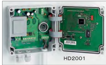
Fig.1 RS232/RS485、アナログ出力選択ディップスイッチ
