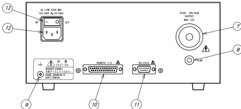
⑦HIGH VOLTAGE 端子 試験電圧出力の高電圧側端子、試験中は高電圧を出力します。
